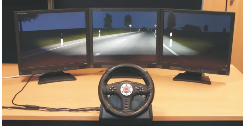
그림 7: LucidDrive를 활용한 사실에 근접한 야간 주행 시뮬레이터
