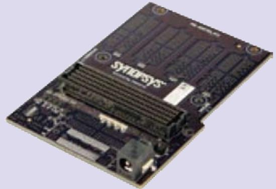
HAPS-DXシステムには、2つのHapsTrak 3-FMCアダプタ・ボードを装着できます。各アダプタ・ボードには400ピンHPC (High Pin Count) コネクタへのインターフェイスがあり、Virtex-7 690T FPGAの160本のシングルエンドI/Oおよび10個の差動GTH I/Oにアクセスできます。
