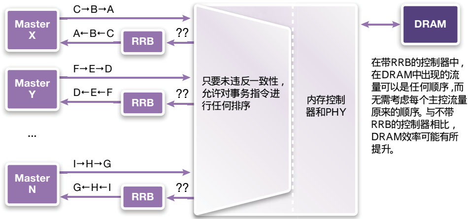
图4: 带读取重排序缓冲器的多主控系统能够以最优化的顺序在存储总线上执行事务, 同时能够以与向内存控制器发出事务的顺序重新调整数据并向每个主控或ID发回响应
