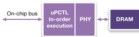
图7: Synopsys DesignWare uPCTL Controller的框图，用以表示不带读取重排序缓冲器的在线控制器
