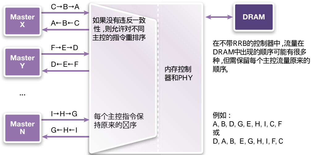
图3: 在典型的多主控系统中, 每个主控将以设定的顺序向DRAM控制器发出指令, 并将预计以发出指令的顺序返回这些指令的响应
