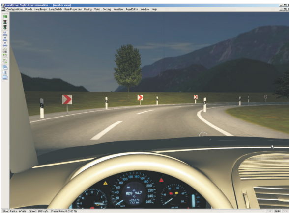
图4：借助方向盘与踏板插件可实现逼真的驾驶体验
